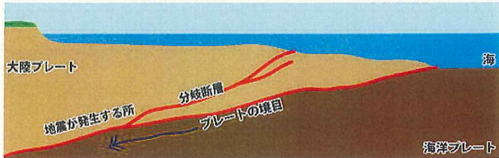
【図13 分岐断層 (出典：国立研究開発法人海洋研究開発機構ホームページ)】
