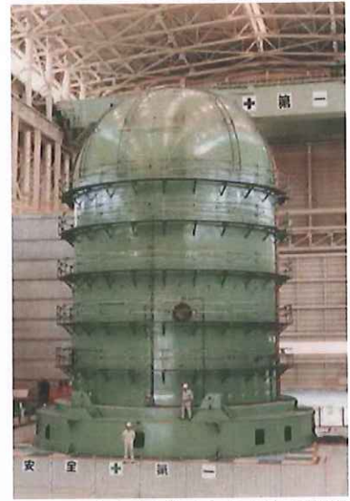
PWR原子炉格納容器 鋼製 [縮尺:1/3.7, 重量:350ト (実機:約3,800ト)]
