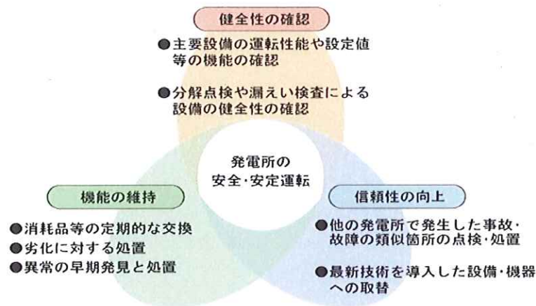
図1 原子力発電所の定期検査の目的
