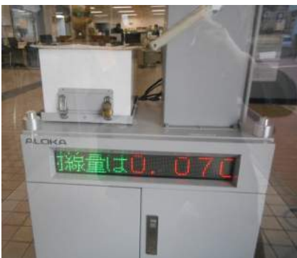
佐賀県江北町役場の可搬型モニタリングポスト。低線量・高線量一体型。この日は数値表示がされてなかったのですが、担当職員に話をし、正しく表示するようにさせた。0.07 \mu Sv/hだった。
