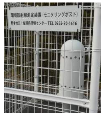
佐賀県環境センターの固定型・低線量モニタリングポスト
