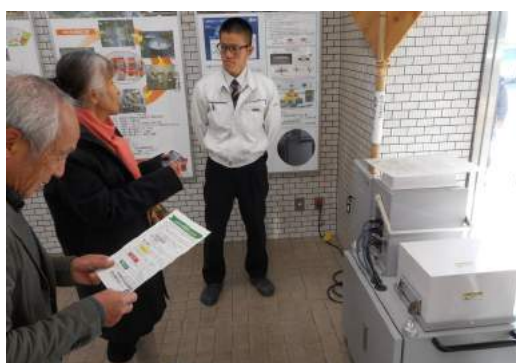
佐賀県江北町役場の可搬型モニタリングポスト。低線量・高線量一体型。この日は数値表示がされてなかったのですが、担当職員に話をし、正しく表示するようにさせた。0.07 \mu Sv/hだった。
